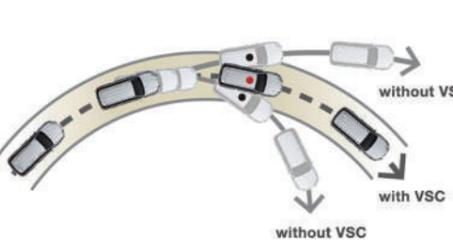
**VSC:** يساعد على منع الزلزال العجلات الأمامية أو الخلفية أثناء دوران المنعطفات وذلك عن طريق خفض قدرة المحرك واستخدام قدرة الفرامل على العجلات التي تحتاج إليها. <sup>٣</sup>
