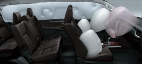
**أكياس الهواء:** سيارة فورتنر مجهزة بأكياس هوائي SRS للسائق وكييس هوائي SRS للراكب الأمامي وكييس هوائي SRS للركبتين (مقعد السائق) وكييس هوائي SRS جانبي (المقاعد الأمامية) وأكياس الدرع الستائري (SRS) للمقاعد الأمامية والخلفية).<sup>١</sup>
