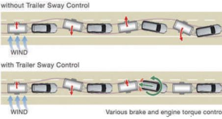
**التحكم في تمايل المقصورة:** عند قطر مقصورة، يرصد النظام أي تمايل في المقصورة ويساعد على كبحه عن طريق التحكم في الفرملة وقدرة خرج المحرك. <sup>٣</sup>
