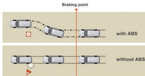
**نظام ABS (المكابح المانعة للانغلاق) مع EBD (نظام التوزيع الإلكتروني لقوة المكابح):** حيث تعمل هذه المكابح على عدم انغلاق الإطارات بشكل كامل أثناء الكبح على الطرقات الزلقة أو أثناء الكبح الطارئ. أما نظام EBD فيعمل على توزيع قوة الكبح على أي نوع من أنواع الطرق المختلفة. <sup>٣</sup>
